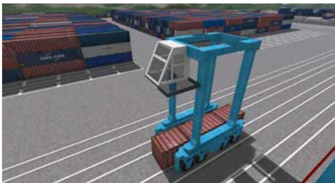
**L'avis du professeur** : Hamza n'a pas pu expliquer la construction du cavalier car il l'a fini la veille de l'impression du livret. Les techniques de construction sont assez similaires à la grue en plus simple, on s'est aussi beaucoup aidé des dimensions des conteneurs puisque le cavalier doit avoir une largeur quasi identique et au moins une taille trois fois plus grande qu'un conteneur pour pouvoir les empiler.
